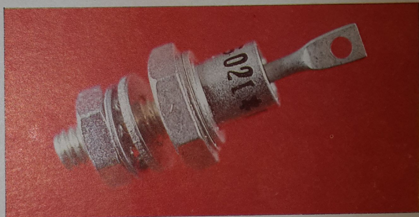
Diodo rectificador de alta potencia. La configuración de su cápsula permite que pueda montarse sobre un radiador.
