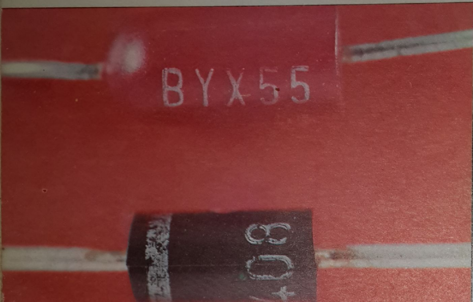
Diodos rectificadores de baja potencia, con encapsulado plástico. El terminal catódico de ambos está situado a la izquierda.
