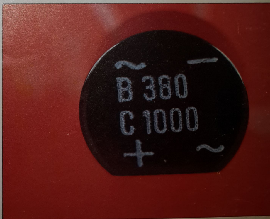
Encapsulado común de cuatro diodos semiconductores en montaje «puente».
