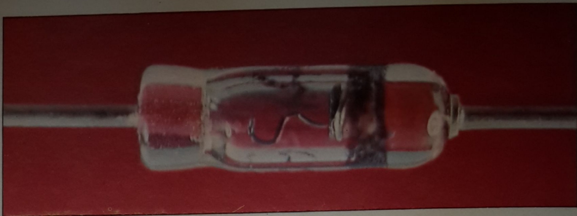
Fotografía de un diodo de punta en la que se puede observar el «bigote» de hilo que realiza la unión.
